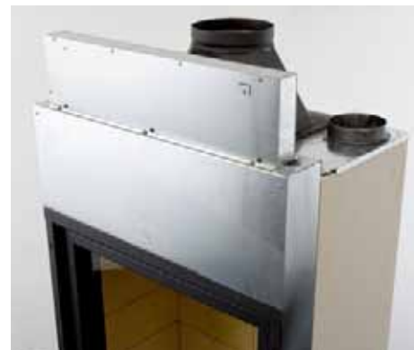
Stûv 21/85 com elevação total (configuração standard): a elevação permite elevar completamente o vidro. O dique é perfilado para favorecer a tiragem.
